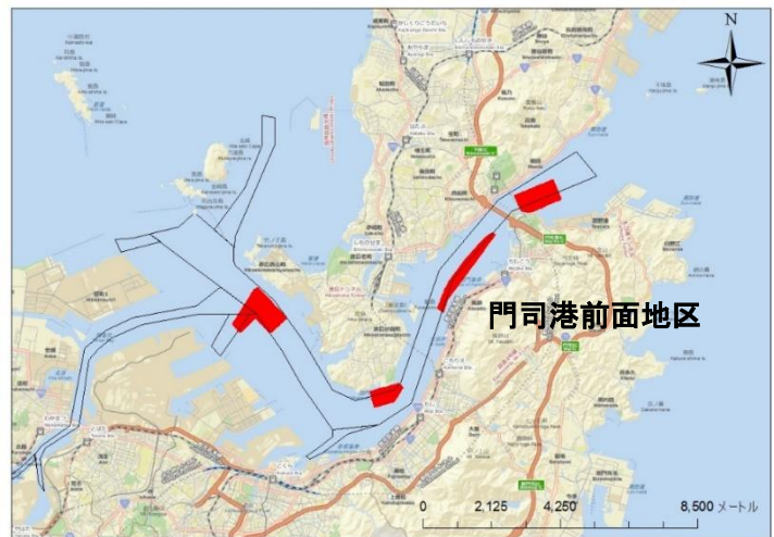
図-1 関門航路サンドウェーブ発生箇所
