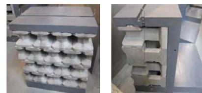
写真-1 直立消波ブロック模型 (左:正面, 右:側面)
